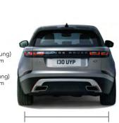
Spurweite hinten (Stahlferderung) 1'657,2 mm Spurweite hinten (Luftferderung) 1'662,8 mm
